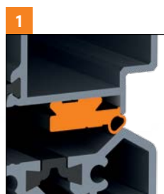
DODATKOWA USZCZELNIKA EPDM USZCZELNIA POŁĄCZENIE SKRZYDŁA Z PROGIEM
