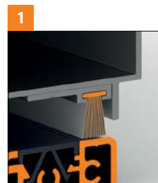
DODATKOWA USZCZELKA SZCZOTKOWA DOSZCZELNIAJĄCA POŁĄCZENIE SKRZYDŁA Z PROGIEM
